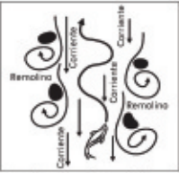
Los remolinos mueven a los peces hacia adelante y hacia atrás en dirección contraria a la corriente del agua.
